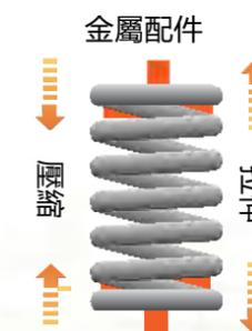
在兩端安裝金屬配件，用一條彈簧能因應壓縮方向和拉伸方向的施力。彈簧尺寸為外徑約600mm、高1200mm，重量則相當沉重，約有800kg。東京晴空塔的TMD各安裝有4條壓伸彈簧，藉由彈簧的剛性來設定、調整TMD的周期。
