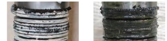
Ein weiteres wichtiges Element stellt die Auswahl des optimalen Fettes dar, um die Schmierung der Tellerfedern aufrechtzuerhalten. Welches ist das optimale Fett für den Einsatz in der Hauptspindel eines Bearbeitungszentrums? Basierend auf den Erkenntnissen, die wir durch die ständige Wiederholung von Vergleichstests an den einzelnen Produkten gewonnen haben, schlagen wir das optimale Schmierfett vor.
