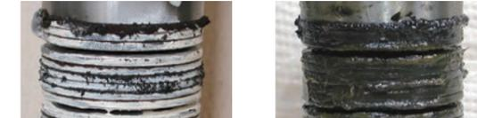
Un altro elemento importante è la scelta del grasso ottimale per mantenere la lubrificazione delle molle a tazza. Qual è il grasso ottimale da utilizzare all'interno del mandrino principale di un centro di lavoro? Proponiamo il grasso ottimale basandoci sulla conoscenza acquisita attraverso test comparativi costanti su ciascun prodotto.
